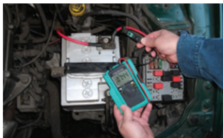
Figura 4. Medição da corrente DC de uma bateria de 12 V de automóvel.
