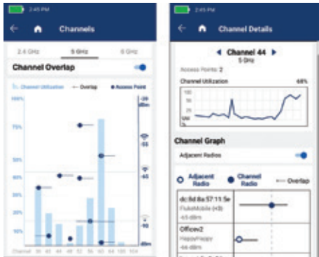
Figura 6. Esquerda: utilização de cada canal na largura de banda de 5 GHz que exibe AP's e a sobreposição para cada um. Direita: detalhes de um canal individual mostram a utilização ao longo do tempo e os detalhes dos rádios sobrepostos com esse canal.
