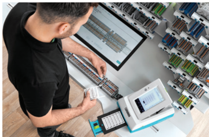
Figura 2. Posto de trabalho de montagem de réguas de bornes com suporte digital.
