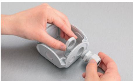
Em alternativa é possível recortar as membranas para colocação de buçins para entrada de cabos (M20 e M16).
