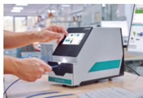
A nova máquina de descarte automática E.Fox S 10 da Phoenix Contact permite o descarte de fios de forma fácil e eficiente, com resultados consistentes e de alta qualidade. As lâminas especiais, em forma de V, cobrem uma faixa de secção transversal de 0,08 a 10 mm<sup>2</sup>. Com a lâmina plana opcional, processa cabos de fita plana até uma largura de 7,6 mm.
