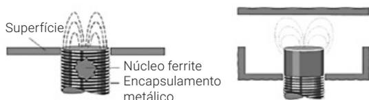
Figura 11. Encapsulamento do sensor indutivo.
