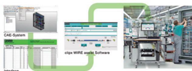
**Figura 4.** O *software* Clipx Wire Assist permite a fácil importação de dados CAE, bem como o processamento estruturado e eficiente do conteúdo do projeto.
